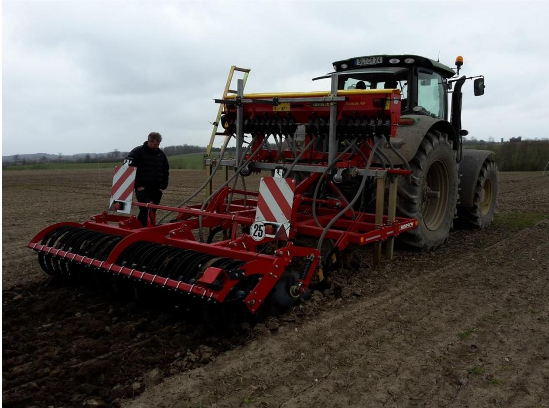
**Abbildung 3: Grubber mit Düngetechnik bei der Vorbereitung der Sommerweizenaussaat**
